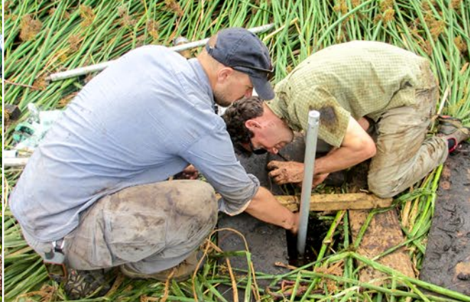
▼ Extracción del barreno con las muestras en el humedal / Extraction of the corer containing the samples from the wetland.
