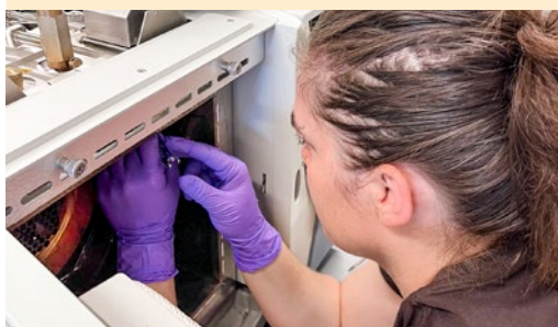
Redmond Stein colocando una muestra en un equipo en el laboratorio de Geoquímica Orgánica del Observatorio de la Tierra Lamont-Doherty. Para analizar las moléculas de las ceras de hojas extraídas de las muestras se usa un cromatógrafo de gases / placing a sample into a piece of equipment in the Organic Geochemistry Laboratory at the Lamont-Doherty Earth Observatory. A gas chromatograph is used to analyze the molecules of leaf waxes extracted from the samples.
